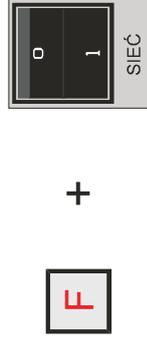
Przytrzymać przycisk "F" i włączyć zasilanie włącznikiem sieciowym. Po pojawieniu się napisów na wyświetlaczu zwolnić przycisk "F".
